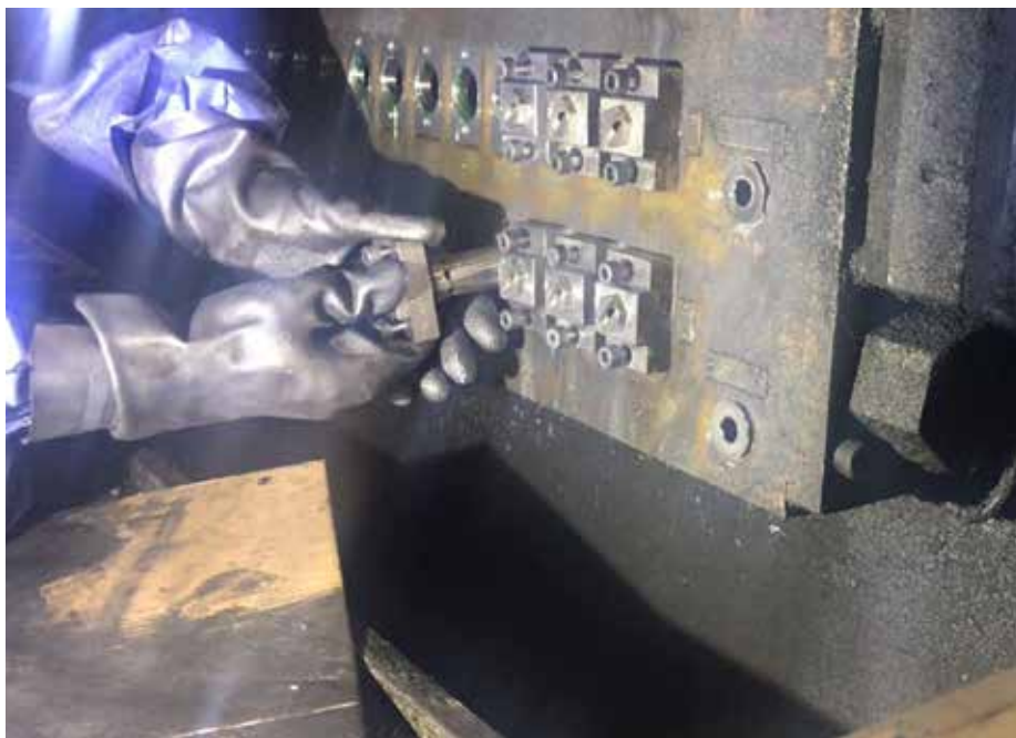
Die einzeln angesteuerten Ventile können auch mit Handschuhen einfach ein- und ausgebaut werden (Foto: Evertz Hydrotechnik GmbH)
