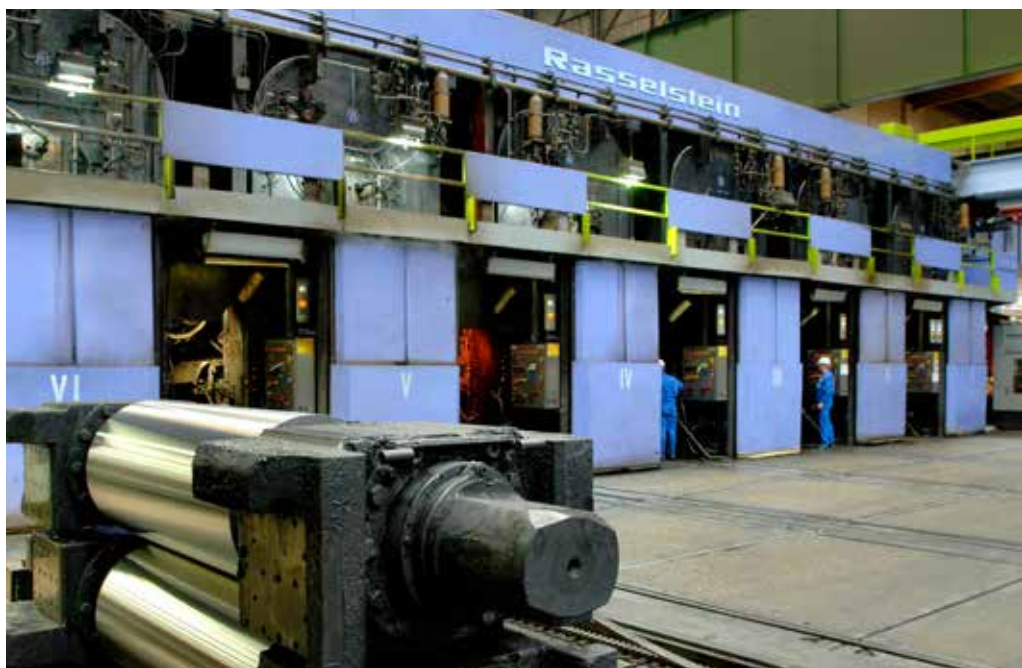
Das neue Sprühsystem kühlt die Walzen des Tandemgerüstes der Rasselstein GmbH in Andernach (Foto: thyssenkrupp Steel Europe)
